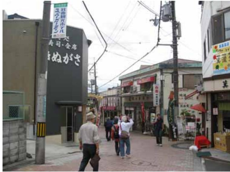
電柱供架型の照明を用い、ポール類の乱立を避ける。
