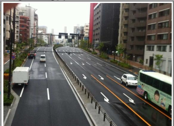
写真 幹線道路における停車帯設置事例
