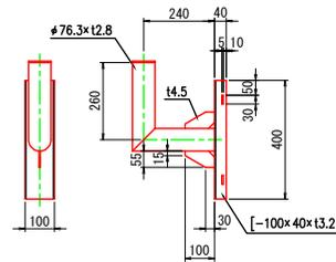
電柱取付金具詳細図 S=1/10
