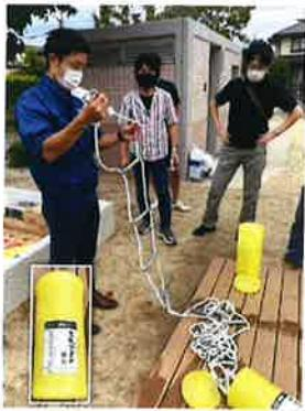
左の写真はステップダンというロープ梯子で、7.7m(3階程度の長さ)あります。フックをひっかけてステップを降りられるようになっています。右の写真は油圧ジャッキ。台部分で5t、爪部分で2tまで、瓦礫などを持ち上げることができます。
