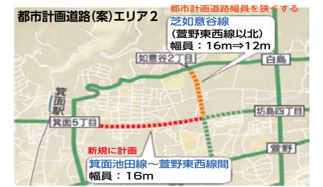
※芝如意谷線や、箕面池田線～萱野東西線間の都市計画道路のルート案について、検討しています。
