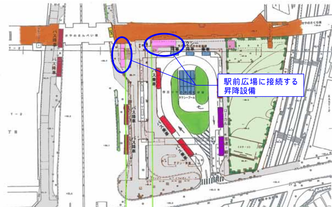
図 (仮称)新箕面駅における昇降設備の設置イメージ
